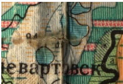
Рис. 3. Зоны деформации из-за сгиба и реставрации
