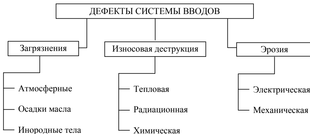
Рисунок 1.3. Классификация дефектов в системе вводов
