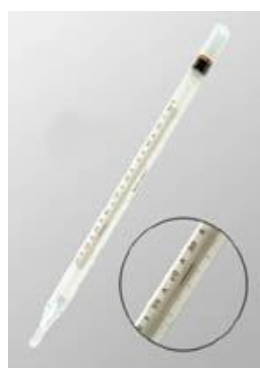
Рис. 11. Термометр метеорологический стеклянный типа ТМ-2
