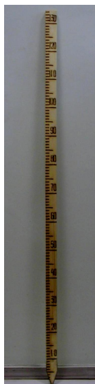
Рис. 22. Рейка снегомерная переносная М-104-1/2
