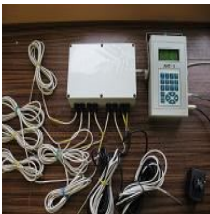
Рис. 13. Термометр почвенный АМТ-5
