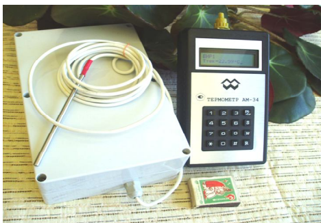
Рис. 15. Термометр почвенный АМ-34
