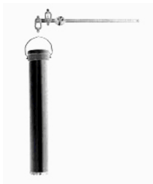
Рис. 23. Снегомер весовой ВС-4 (общий вид)
