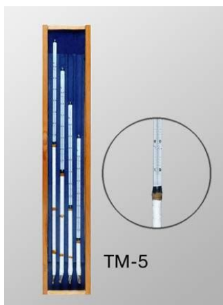
Рис. 12. Термометр метеорологический стеклянный типа ТМ-5
