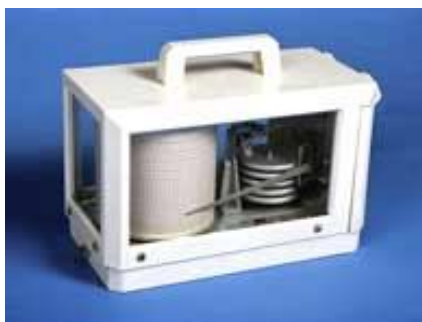
Рис. 35. Барограф метеорологический М-22А (общий вид)
