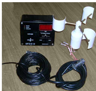
Рис. 42. Анемометр сигнальный цифровой М-95-ЦМ
