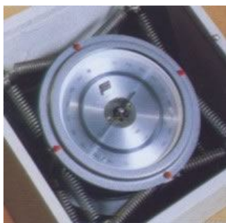
Рис. 34. Барометр-анероид контрольный М-67
