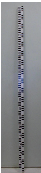
Рис. 21. Рейка снегомерная стационарная М-103-1/2
