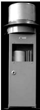
Рис. 19. Плювиограф П-2М (общий вид)
