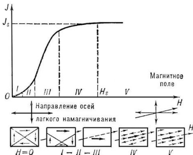
Рис. 8. Кривая первого намагничивания: а — кривая первого намагничивания; б — схематическое изображение процессов намагничивания в многодоменной ферромагнетике
