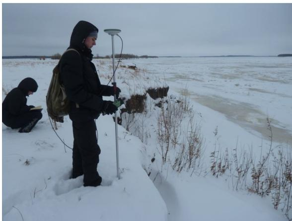
*Рис. 49. Приемник Leica Viva GS10 с Контроллером Leica CS15 в полевых работах*
