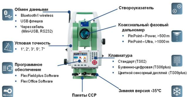
**Рис. 68. Внешний вид тахеометра Leica TS02**
