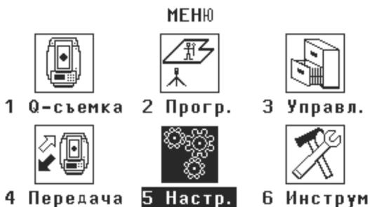
*Рис. 71. Главное меню тахеометров Leica серии FlexLine TS02-06-09*
