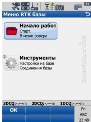
*Рис. 66. Экран контролера. Меню RTK базы*
