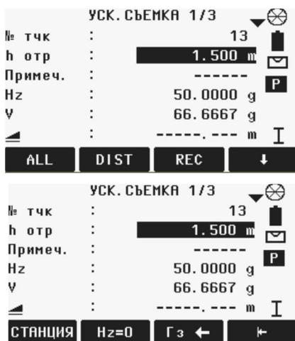
Рис. 72. Меню функции Q-съемка
