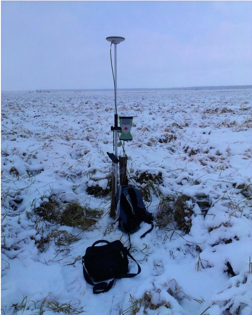
**Рис. 3. Создание съёмочного основания**
