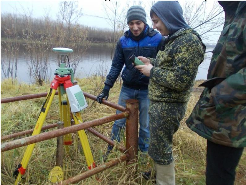
Рис. 2. Установка базовой станции
