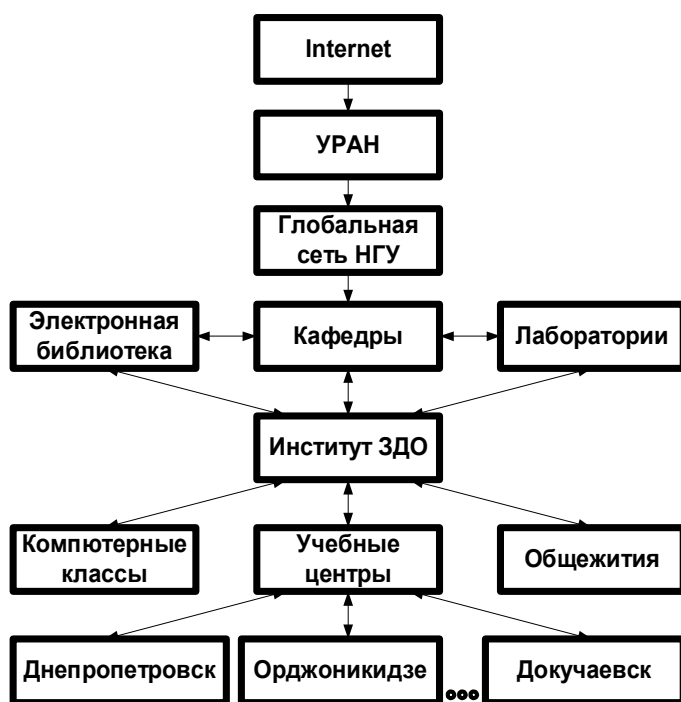
Рис. 1. Структурная схема подключения сетевой среды пользователей ГВУЗ «НГУ»
