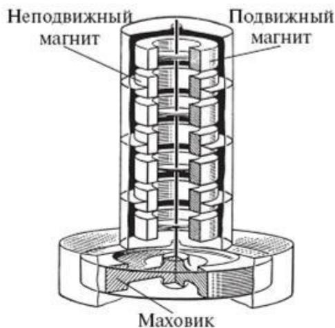
Рис. 2. Магнитная подвеска маховика в виде батареи магнитов
