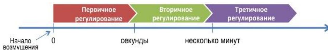
Рис. 4. Время реагирования различных контуров управления
