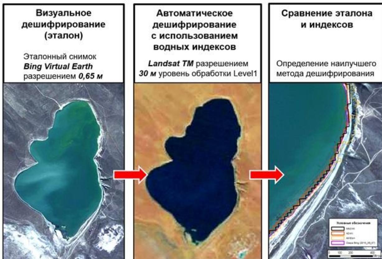
Рис. 5. Сравнение методов дешифрирования гидрологии
