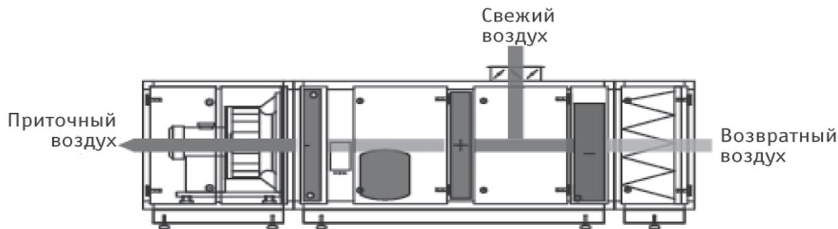
Рис. 1. Принцип работы агрегата DANX AF в дневное время в холодный период года
