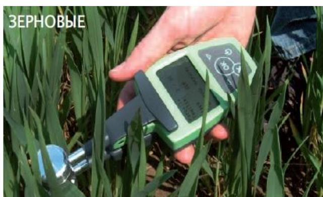
Рис. 1. Инновационный аппарат флавоноид- и хлорофилло- метр DUALEX – 4 (Франция)
