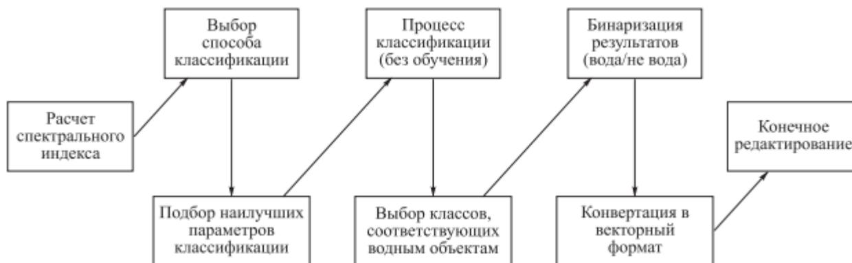
Рис. 4. Схема автоматизированного дешифрирования водных объектов
