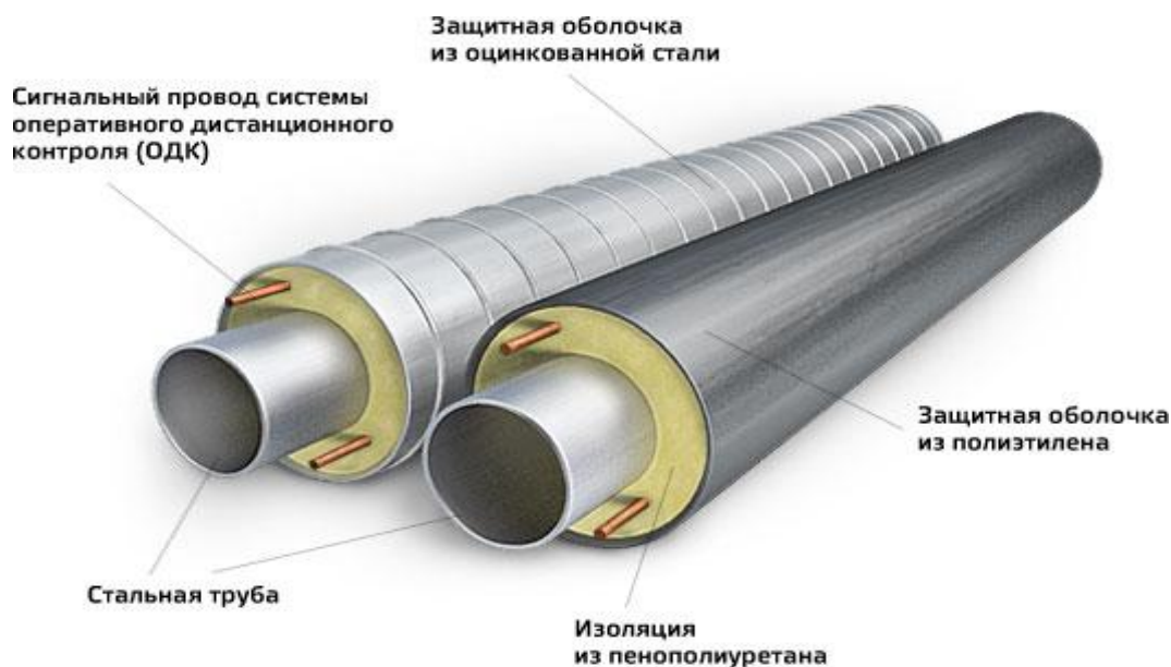
Рис. 4. Виды теплоизоляции трубопровода
