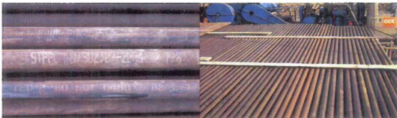
Рис. 3. Наружная поверхность опытной партии НКТ с «АнтиАСПО-80» после 444 суток эксплуатации
