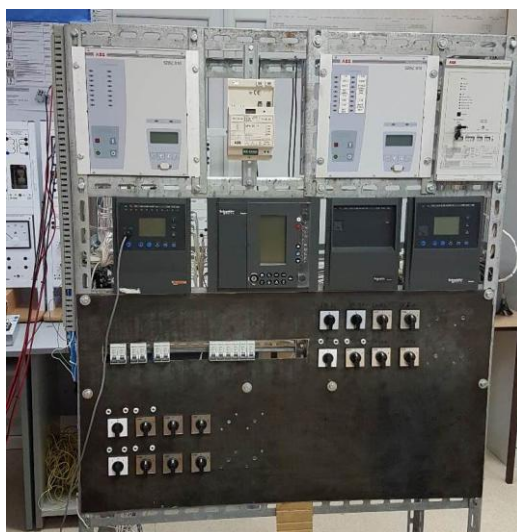
Рис. 1. Стенд с промышленными образцами терминалов РЗА
