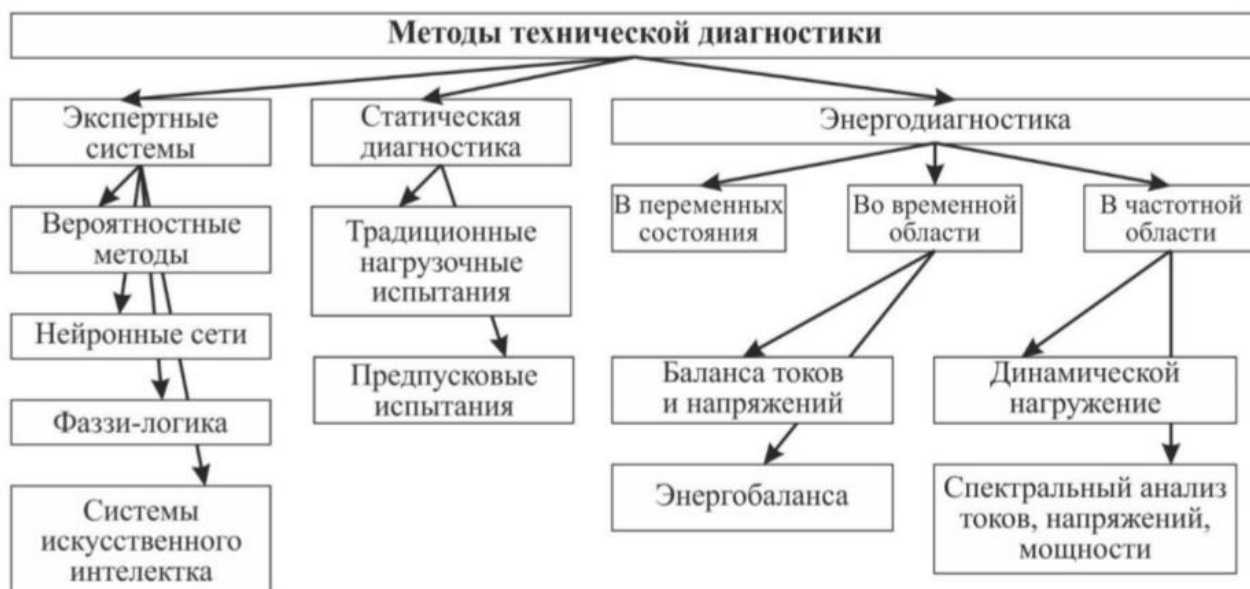
Рис. 2. Структура методов диагностики технического состояния электрических машин
