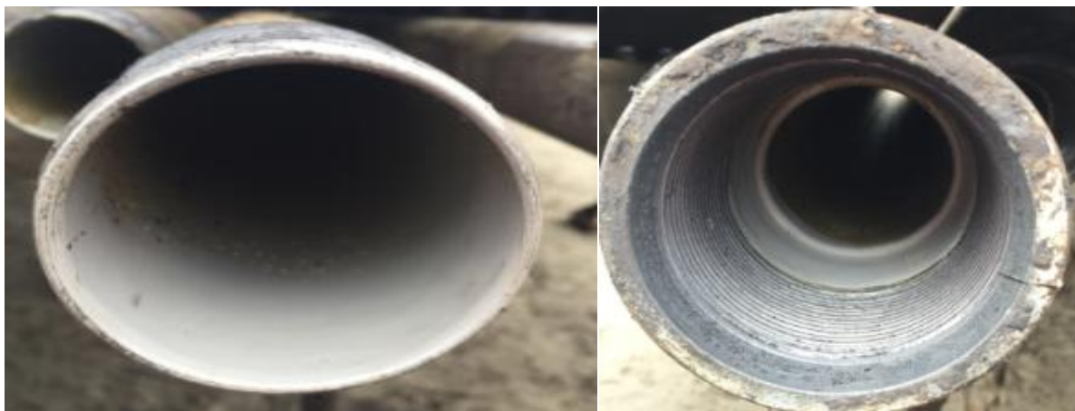
Рис. 2. Внутренняя поверхность НКТ с покрытием «АнтиАСПО-80»
