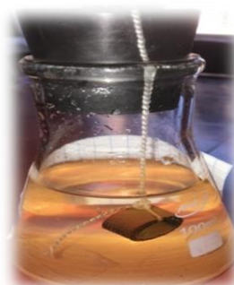
без ингибитора коррозии
