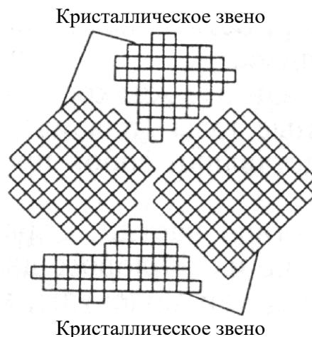
Рис. 3.4. Строение поликристаллического тела
