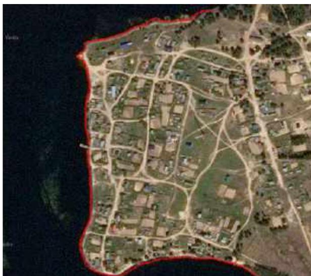
**Рис. 4.4. Зона размыва береговой линии д. Кама: состояние на 2018 г. М 1:125 000**
