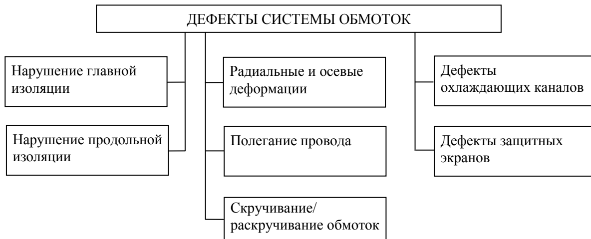
Рисунок 1.2. Классификация дефектов в системе обмоток
