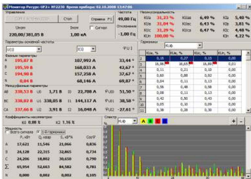
Рисунок 2.9. Скриншот результатов анализа ПКЭ программой «Монитор», прибора Ресурс UF-2
