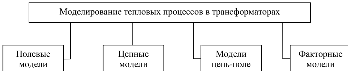
Рисунок 3.1. Модели тепловых процессов в силовых трансформаторах
