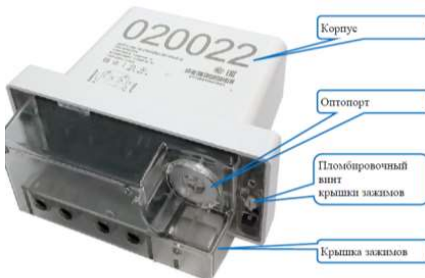
Рис. 5. Основные узлы наружного счетчика
