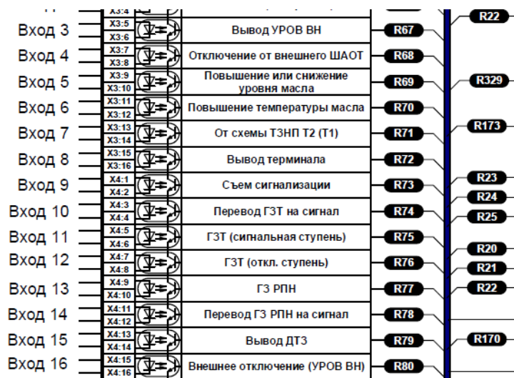
Рис. 39. Фрагмент схемы дискретных входов в РЭ терминала
