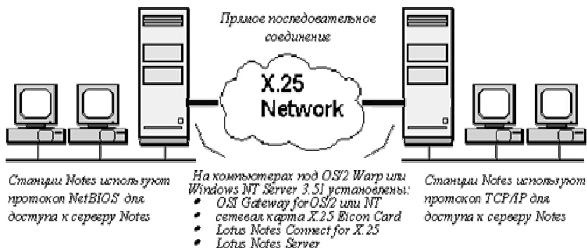
Рис. 5.3. Пример постоянного последовательного соединения двух серверов
