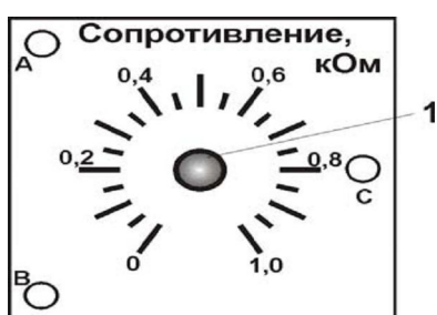
Рис. 1.11а. Миниблок «Реостат» 1 — ручка изменения сопротивления АС
