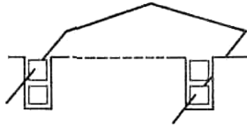
Рис. 13. Расположение в пазах секции двухслойной обмотки
